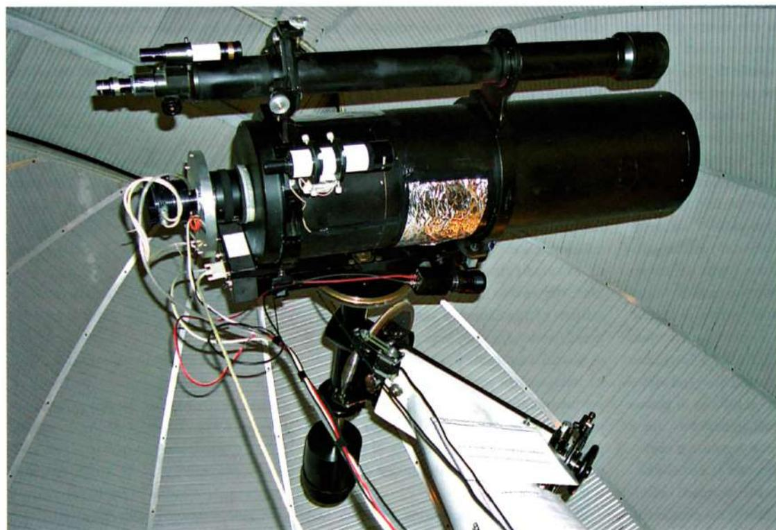
Lo strumento principale dell'Osservatorio di Remanzacco (UD), una Baker-Schmidt da 310 mm abbinata ad una camera CCD HI-SIS 24 e assistita da puntamento automatico Palomar 2000.
