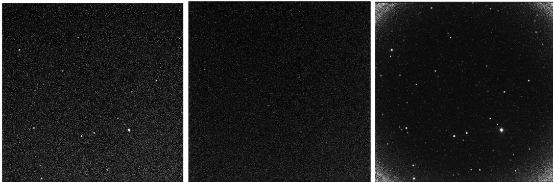
Figura 8.1: Effetti della corrente di dark: a sinistra l'immagine *raw*, al centro il *dark frame* e a destra l'immagine dopo la correzione (le differenze sono molto più evidenti nel PDF, soprattutto se le ingrandite).
