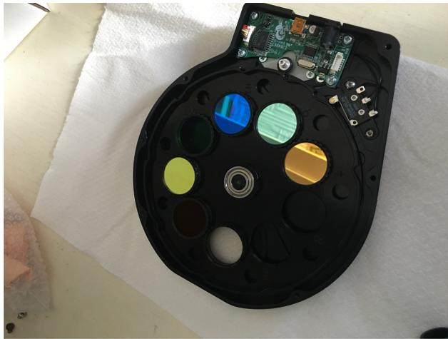
Figura 9.3: Ruota portafiltri, scoperchiata in modo che si possano vedere i filtri UBVRI inseriti nel contenitore girevole.
