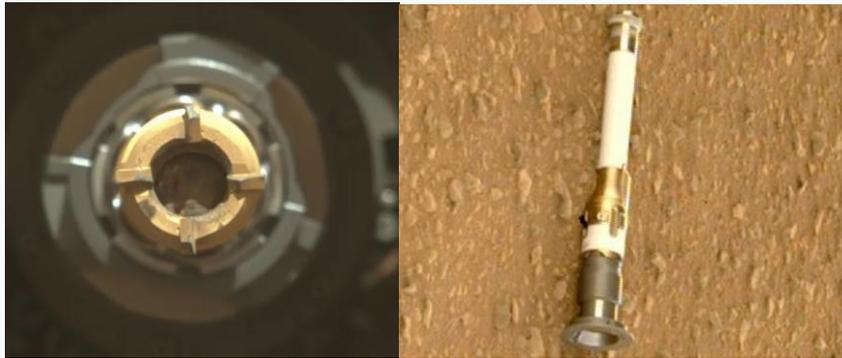
Perseverance utilizzando una speciale punta di carotaggio perfora un cilindro di roccia di **13 mm** di diametro. Mentre il rover perfora, la polvere di roccia si sposta in uno dei **38 tubi** disponibili che conserveranno il campione sigillato, fino a quando non verrà aperto un giorno in un laboratorio sulla Terra.
